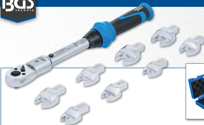
Jeu de clés dynamométriques | pour outils enfichables de 9 x 12 mm | 6 - 30 Nm | 10 pièces
