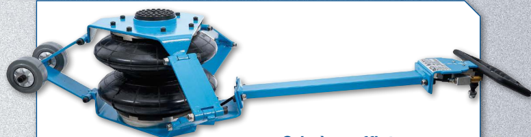
Cric à soufflet pneumatique | mobile | maxi. 410 mm | 2000 kg
