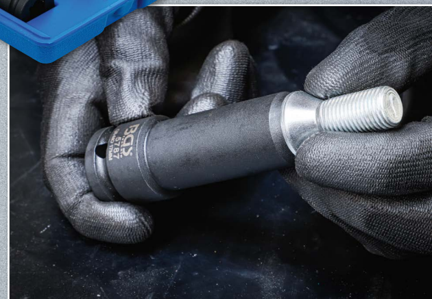
Jeu de douilles à embouts à choc | longueur 75 mm | 12,5 mm (1/2") | six pans intérieurs avec tête sphérique 6 - 19 mm | 8 pièces
